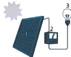
1. Zonnepaneel | 2. Omvormer | 3. Elektrische toestellen
